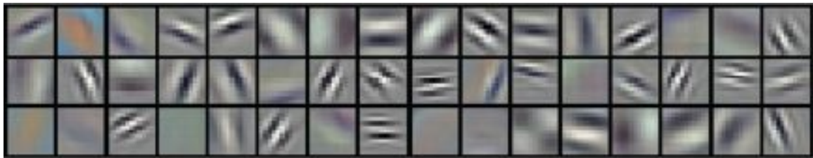
Figura 11 Exemplo de 48 Kernels aprendidos no treinamento do projeto ImageNet classification With CNN
