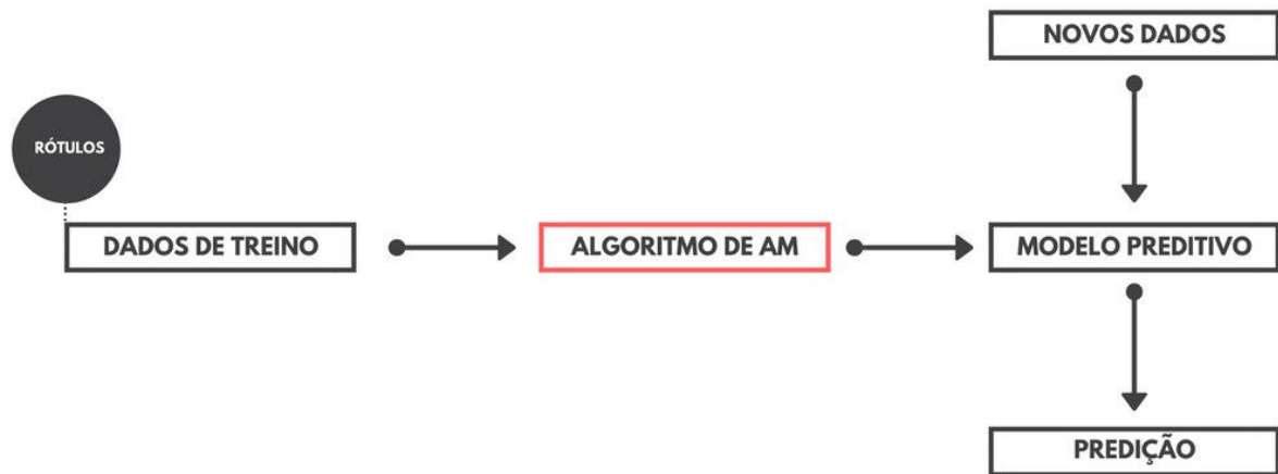
Figura 5 Arquitetura de um sistema de Aprendizado de máquina
