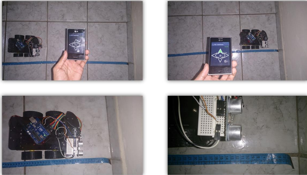
Figura 20: Teste de detecção de obstáculos
