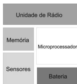
Figura 1 – Arquitetura de hardware de um nó sensor. Fonte: Silva (2006)
