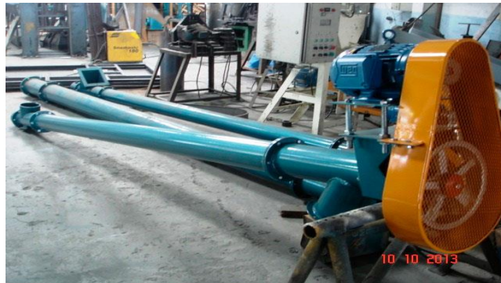
Figura 34 Roscas transportadoras – levam o sal até os outros setores, inclusive, para as calhas (foto representativa)
