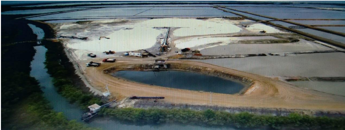
Figura 27 Estocagem do sal grosso ou in natura , onde é realizado o carregamento por meio de caçambas inoxidáveis e transportado para a refinaria
