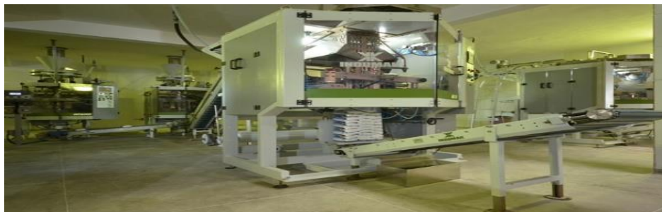
Figura 43 Enfardadeira com esteira automática – são transportados os fardos de 30Kg com pacotes de 1Kg até o colaborador (foto representativa)
