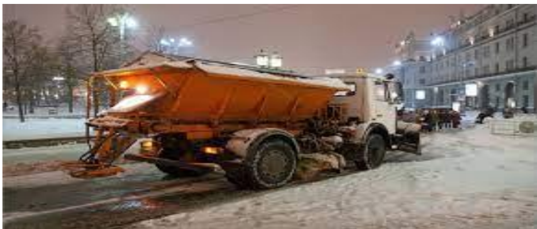
Figura 60 Transporte com sal grosso – caçamba adaptada com lâmina na frente e atrás, mecanismo arriador de produto salina para combater o gelo na estrada (foto representativa)
