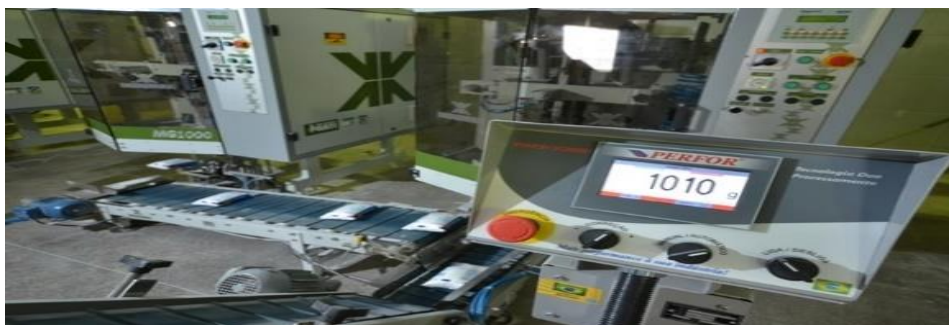
Figura 44 Empacotadeira com esteira e balança automática – pacotes de 1Kg são envazados, transportados e pesados (foto representativa)
