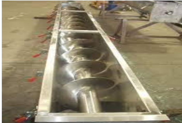
Figura 33 Calha de aço inox – o sal é transportado através dela (foto representativa)
