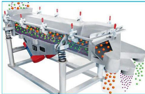
Figura 35 Peneira trepidante – usada para separar os tipos de sais (imagem representativa)
