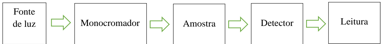
Figura 2.5: Funcionamento de um espectrofotômetro UV-Vis e seus componentes básicos.
