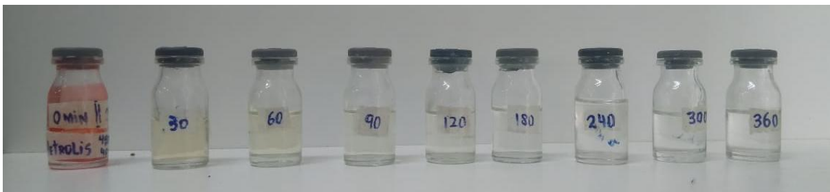
Figura 5.6: Descoloração do corante em intervalos de eletrólise com densidade de corrente de 40\text{mA}\cdot\text{cm}^{-2} em reator de fluxo contínuo.
