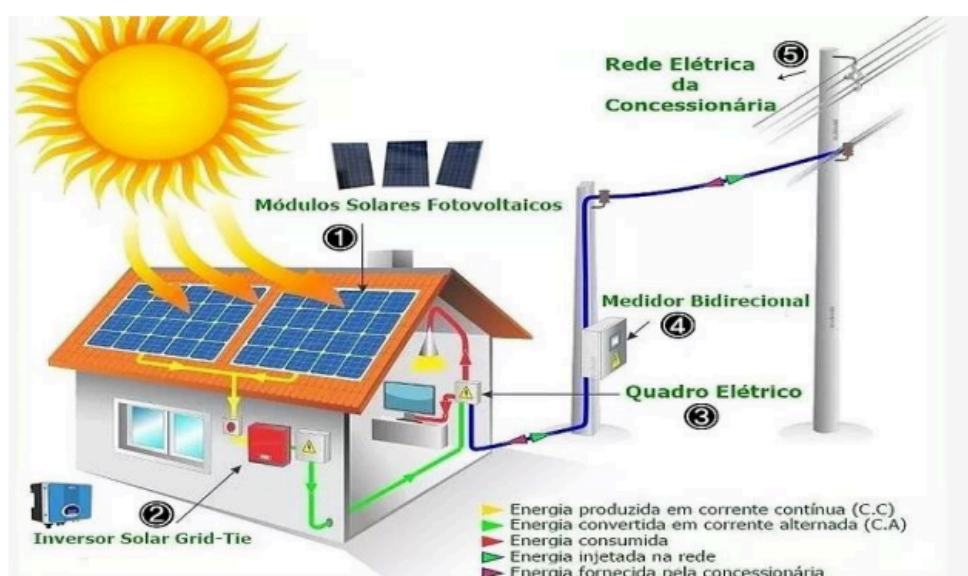
Figura 1 Constituição do Sistema Fotovoltaico.
