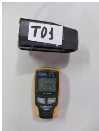
Figura 10: Aparelho termohigrômetro datalogger Impac – modelo IP 747RH
