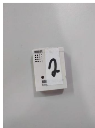
Figura 11: Aparelho termohigrômetro datalogger Onset – Hobo logger
