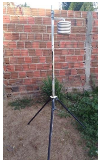
Figura 13: Abrigo meteorológico com a base de ferro e a câmara de plástico
