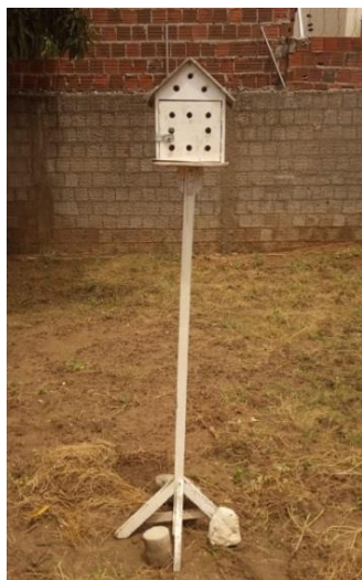
Figura 12: Abrigo meteorológico de madeira
