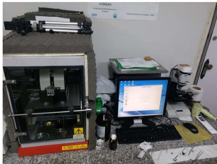
Figura 2: Bancada com equipamento tribômetro HFRR para avaliação do par Esfera-Disco.
