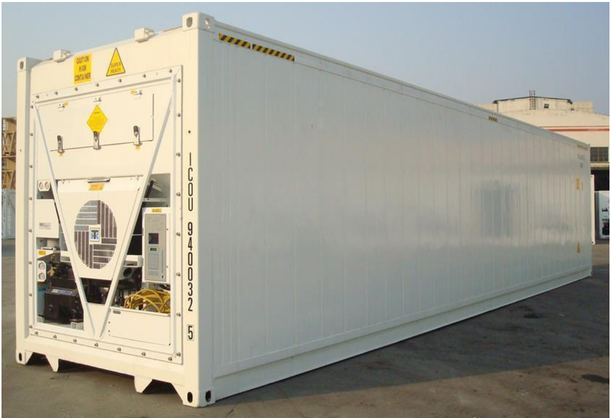
Figura 5: Container do tipo REEFER
