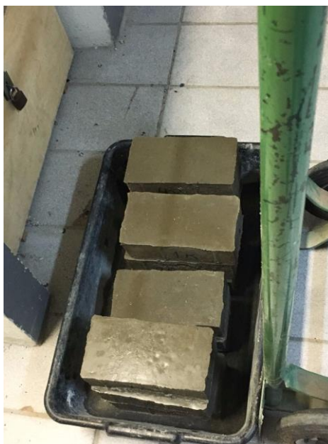
Figura 16: Corpos de provas capeados.
