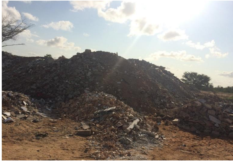
Figura 2: Entulho recebido pela empresa, antes de ser tratado.
