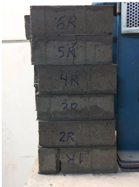
Figura 19: Corpos de prova de resíduos rompidos.
