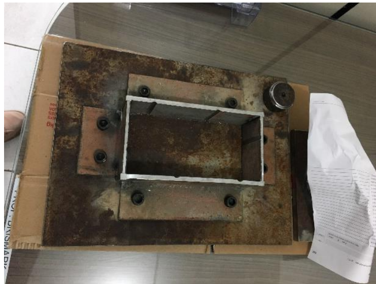
Figura 8: Molde para confecção dos tijolos.
