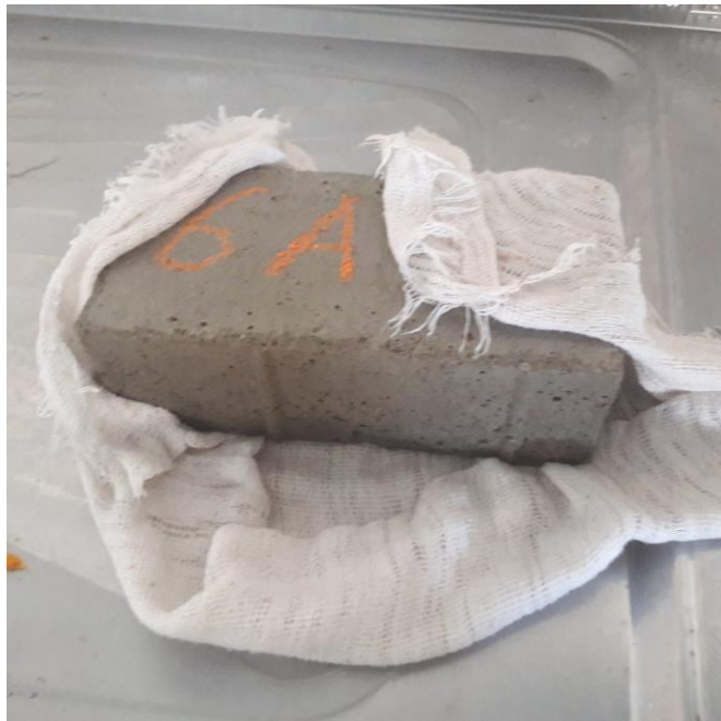
Figura 14: Secagem da superfície dos corpos de prova.
