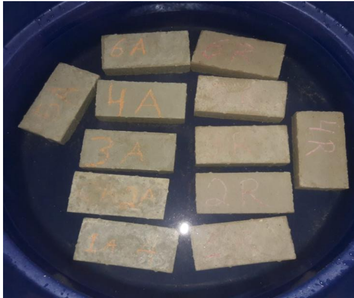
Figura 13: Corpo de provas submersos a água.
