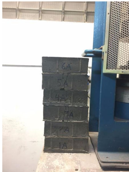
Figura 18: Corpos de provas convencionais rompidos.
