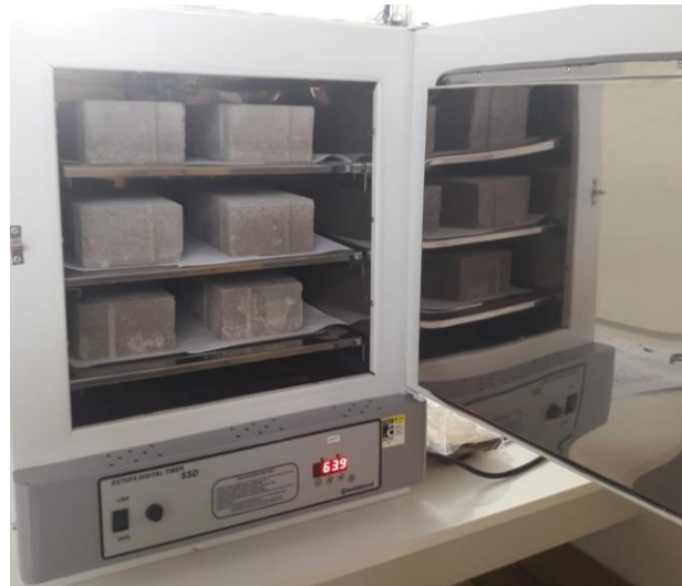
Figura 15: Corpos de provas na estufa para o procedimento de secagem.
