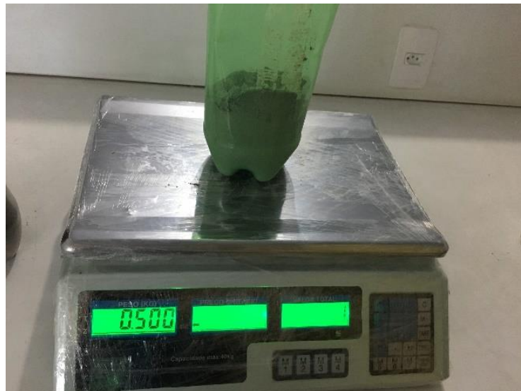
Figura 10: Cimento Portland CP-II-Z-32 sendo pesado.
