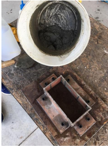
Figura 12: Mistura feita manualmente.
