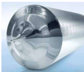
Figura 2 – Lingote de silício monocristalino
