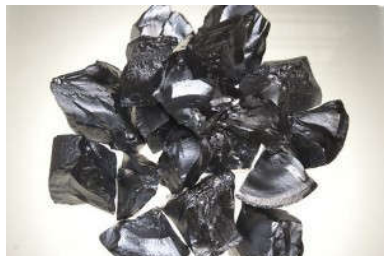
Figura 1 – Cristal de silício ultra puro
