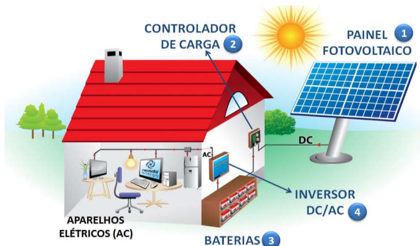
Figura 6 – Sistema de energia solar fotovoltaico isolado
